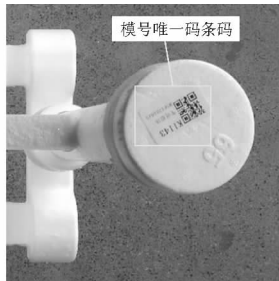
图 8 白模模号唯一码 Fig.8 Module number unique code of white module
